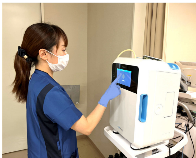
③ タッチパネルのボタンを押して消毒開始。7分間の消毒中は他の業務に充てる。trophon2の設置場所が判読室のため、ちょっとしたデスクワークも可能
